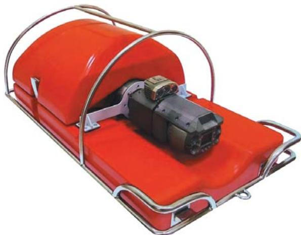
**Рис. 4. Телеинспекционный плот**
