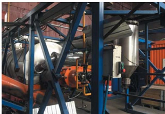
**Рис. 5. Установка термической деструкции**
